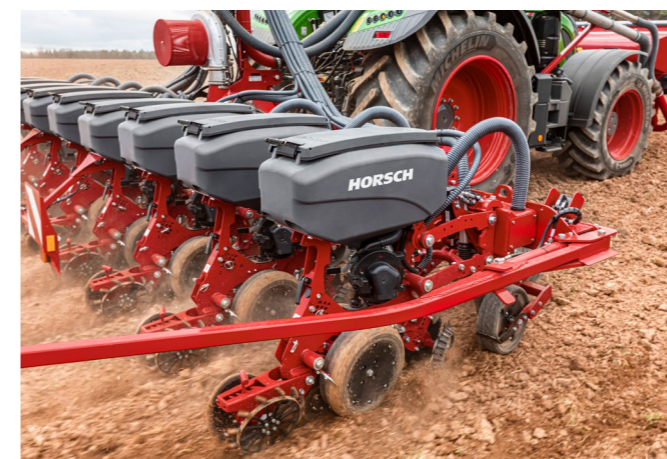
Hydraulické nastavení přitlaku jednotek pro nekompromisní vnikání do půdy
