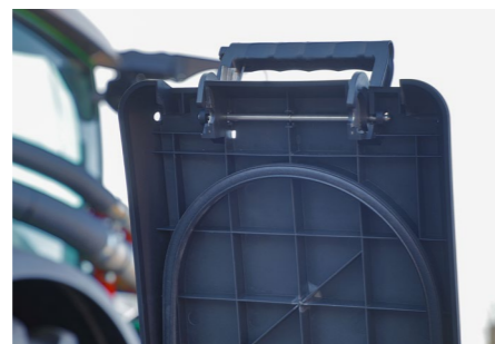
Těsnění víka zásobníku osiva
