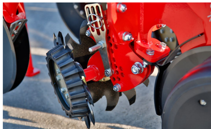
Volitelné hvězdicové odhrnovače rostlinných zbytků, plovoucí s hloubkovým vedením
