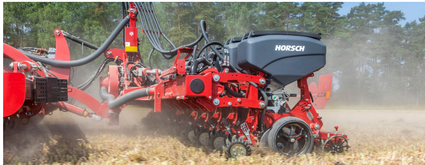
Při setí je k dispozici přítlak až 350 kg na jednotku.
