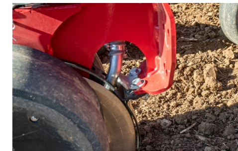
Pneumatická aplikace DO setového lůžka
