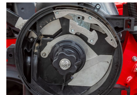
Univerzální jednotící stěrka již není třeba nastavovat
