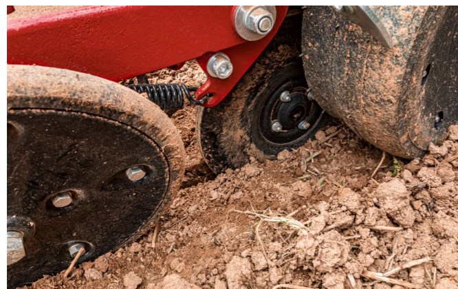
Zachytávací kolečko je rozhodující pro dobrý kontakt semínka s půdou.
