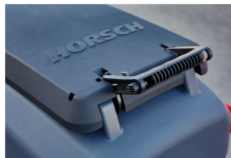
Uzávěr zásobníku na výsevní jednotce
