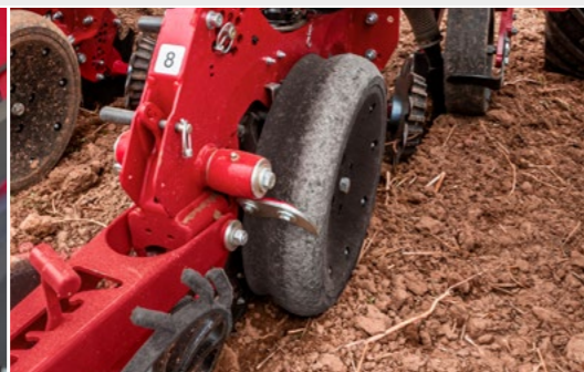
Kolo RID snižuje zhutnění půdy přímo u výsevního řádku ve velmi těžkých půdách nebo v případě přímého setí.
