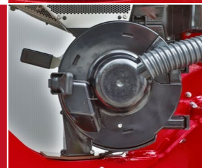
Snadno přístupné dávkovací jednotky s různými dávkovacími kotouči v závislosti na druhu plodiny
