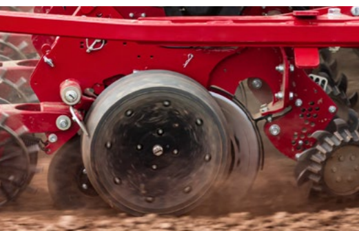
Těžká dvoukotoučová botka s nízkým opotřebením a stabilním vedením hloubky
