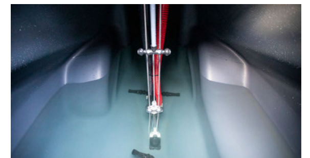
Leeb 4 AX vnitřní pohled na nádrž: výkonné míchací a čisticí trysky
