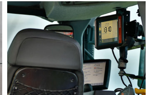
Digitální, snadno čitelné zobrazení hladiny v terminálu
