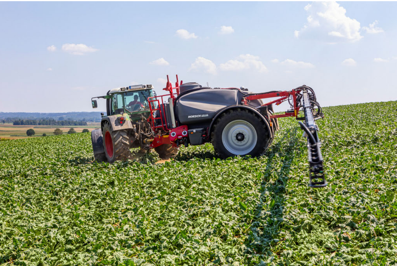
Řízení oje: Ochrana plodin a přesné sledování stopy traktoru
