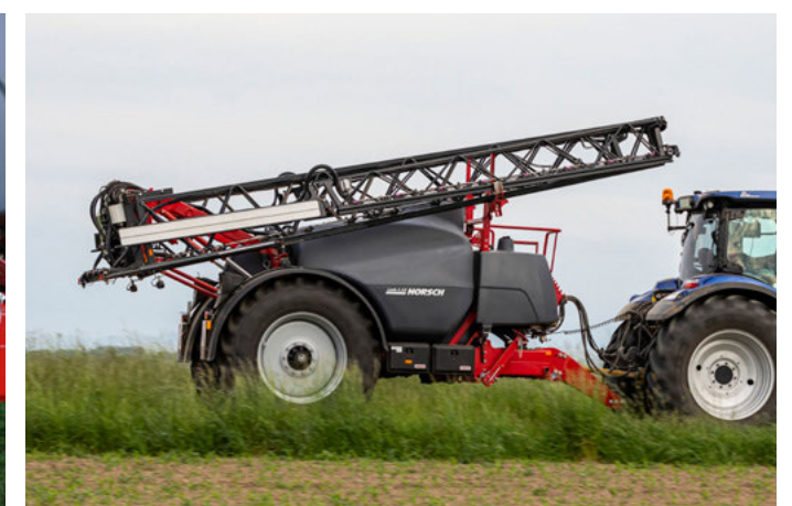
5-dílná ramena s kompaktním sklápěním
