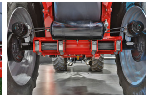
Náprava s mechanickým nastavením rozchodu kol podle pneumatik od 1,50 do 2,25 m
