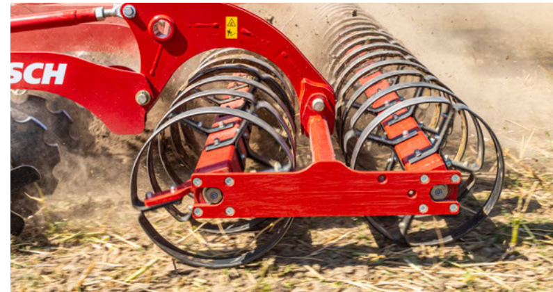
Výkyvný rám dvojitého pčhu pro optimální kopírování povrchu
