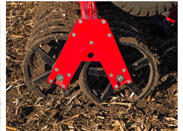
Pevný rám dvojitého pčhu s vysokou samočisticí schopností
