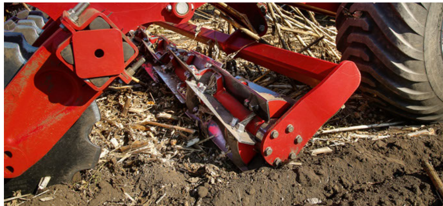
Volitelně s hydraulicky předepnutým nožovým válcem pro dodatečný řezací efekt
