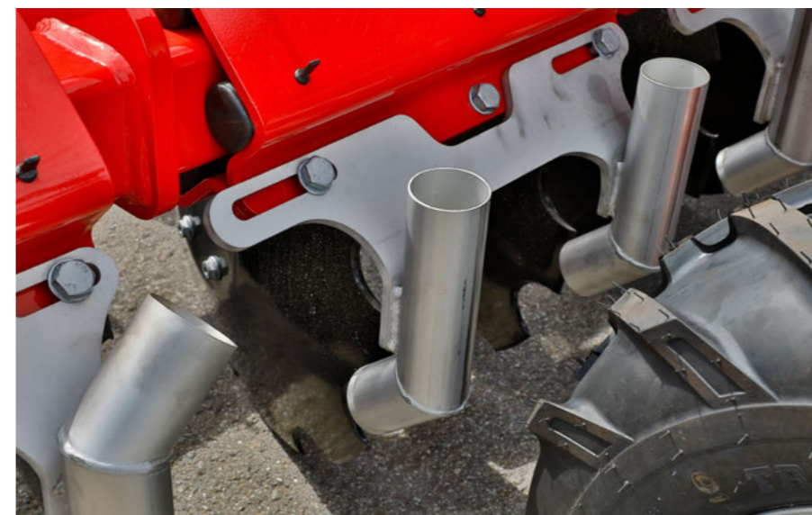
Výpustě na kejdu z nerezové oceli pro maximální životnost
