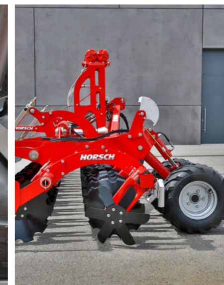
Aplikace kejdy bez pčchu, který je nahrazen branami pro minimální náchylnost k ucpávání
