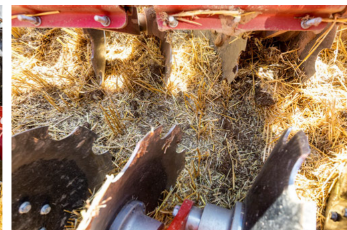
Párové uložení kotoučů pro maximální průchodnost
