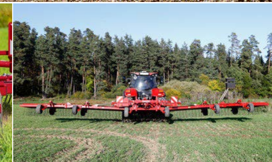
Naklání pomocí dvojité zvedací pístnice při 90° skládání
