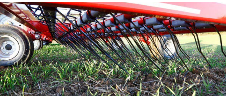
Maximální průchodnost díky výšce rámu a pružinám nad rámem
