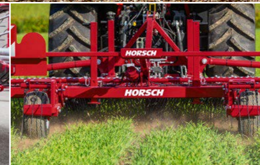
Opěrná kola lze variabilně nastavit podle šířky stopy
