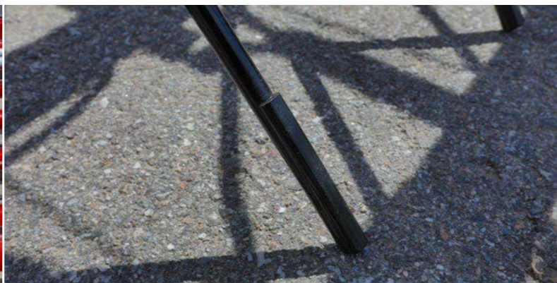
Prut s 60 mm tvrdokovovou ochranou
