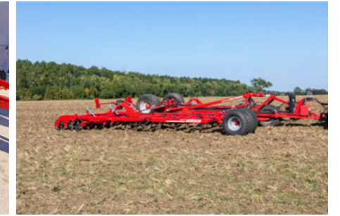
Středové podpěrné kolo pro dokonalé kopírování přes všechny segmenty
