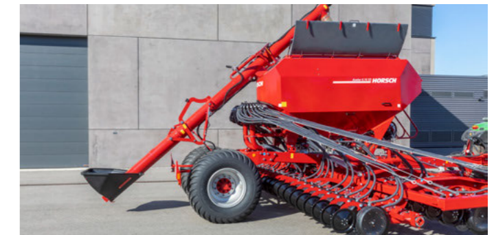
Hydraulický plnicí šnekový dopravník
