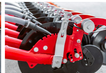
Bezpečné nastavení hloubky setí jednotlivých botek bez použití nářadí s jemným odstupňováním
