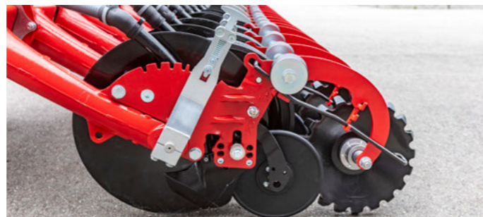
Hvězdicové kolečko drobí půdu a uzavírá seťové lůžko
