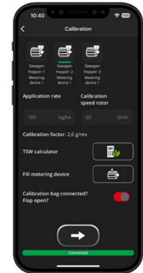
Aplikace HORSCH Control umožňuje ovládání jednotlivých funkcí stroje – zcela pohodlně z chytrého telefonu
