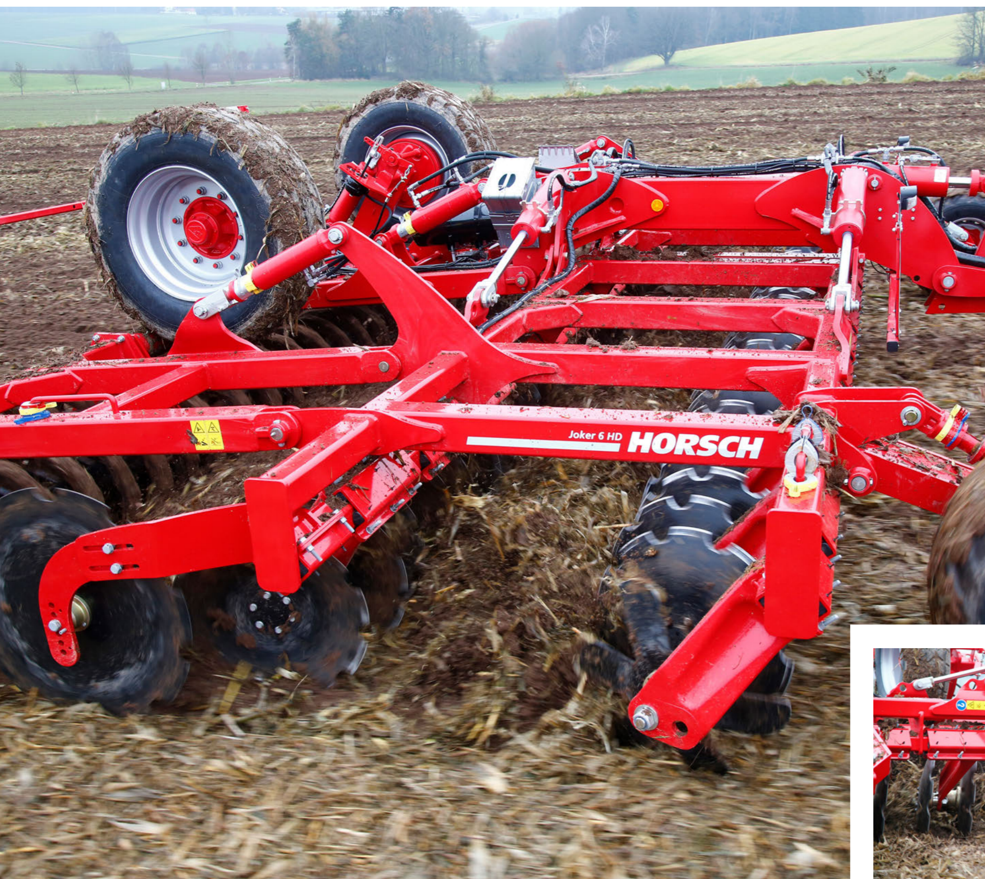
Szerokie łożyskowanie talerzy na ramie zapewnia dokładne ich prowadzenie w glebie
