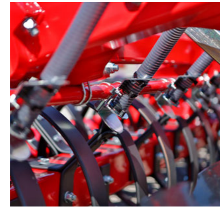
Szyna siewna do wysiewu międzyplonów w jednym przejściu roboczym
