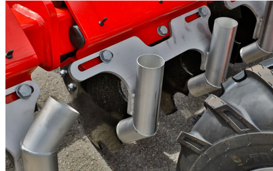
Wyloty gnojowicy ze stali nierdzewnej zapewniające maksymalną trwałość
