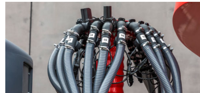
Kontrola przepływu nawozu i nasion zapewnia pełne monitorowanie węzłów siewnych i nawozowych
