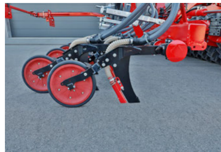
Zębowa redlica siewna TurboEdge
