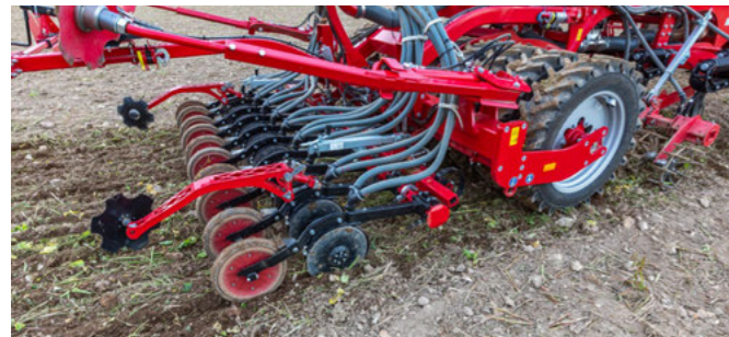
Focus 3 TD z szyną siewną TurboDisc z odstępem między rzędami wynoszącym 30 cm.
