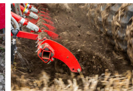
Przy pomocy szyny z wałkami kruszącymi produkowana jest dodatkowa, drobnogruzełkowata gleba
