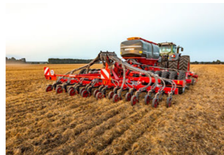
Redlica siewna TurboEdge do siewu przy dużej ilości słomy
