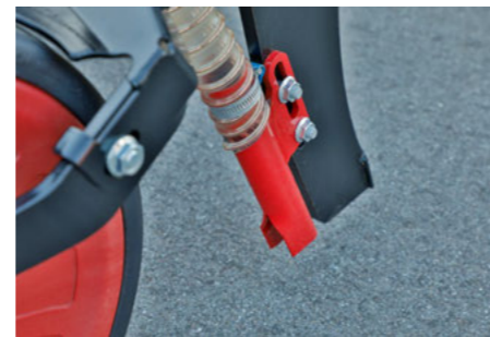
Usuwanie pozostałości organicznych z bruzdy siewnej
