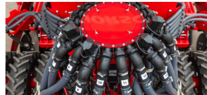
Monitorowanie przepływu powietrza w głowicy rozdzielczej.
