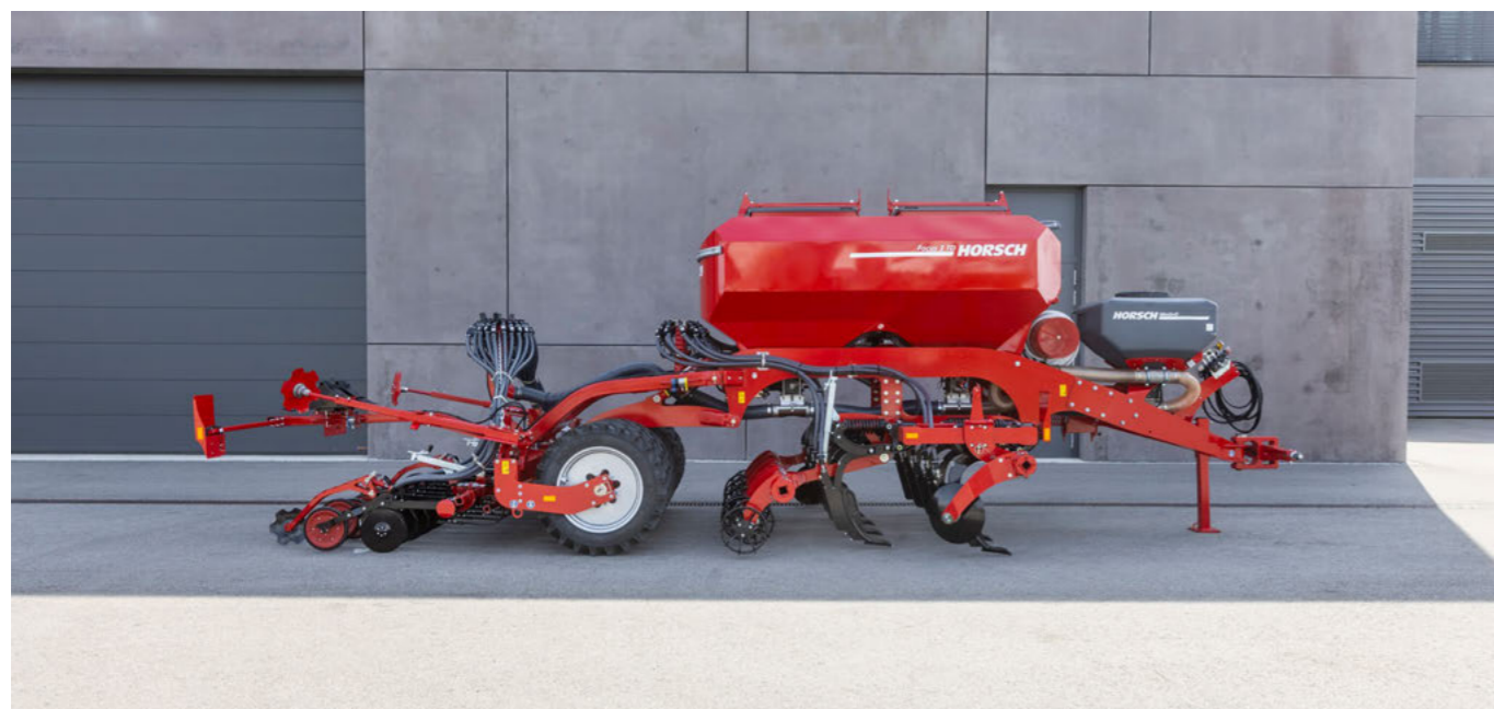
Wał oponowy o dużych oponach zapewniający lekką pracę
