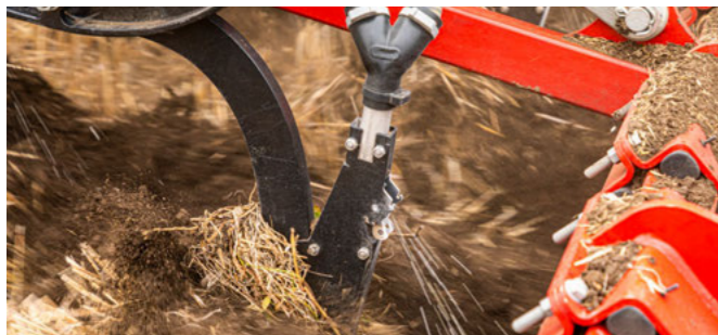
Redlica LD/Redlica LD Plus – aplikacja nawozu w górną warstwę gleby
