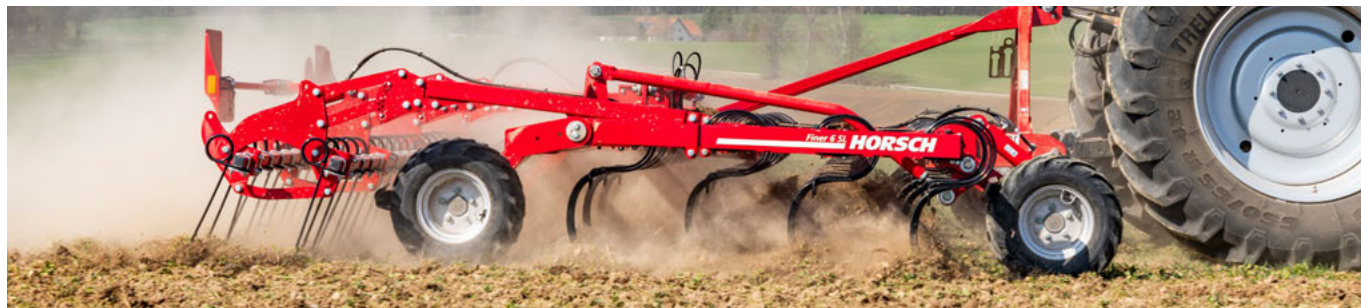
Cztery koła prowadzące na głębokości z zaciskiem na wale.
