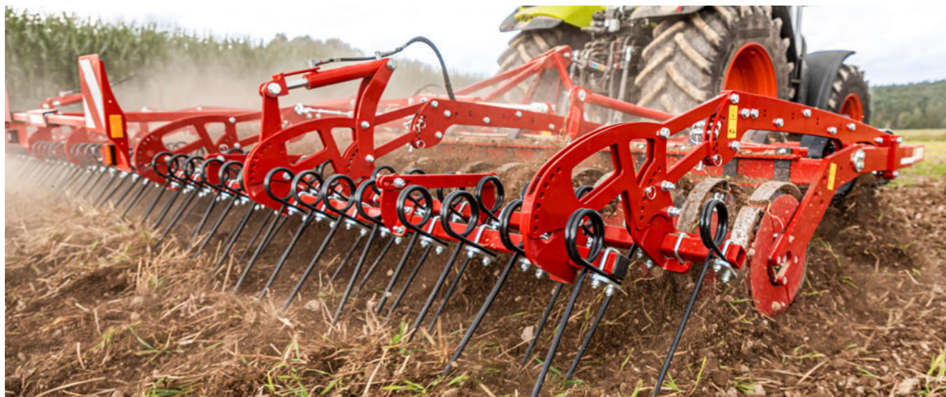
Opcjonalnie z hydraulicznie regulowanym dwurzędowym zgrzebłem
