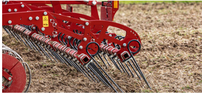
Dwurzędowe zgrzebło z hydrauliczną regulacją agresywności
