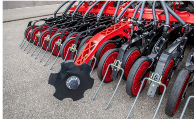
Agresywność znacznika przedwschodowego ustawiana za pomocą ogranicznika głębokości
