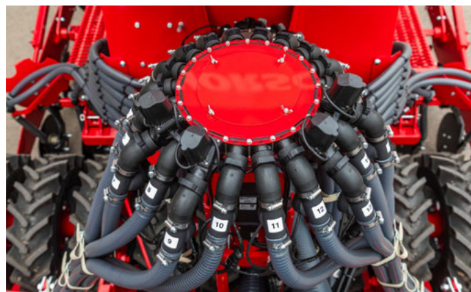
Monitorowanie przepływu powietrza w głowicy rozdzielczej
