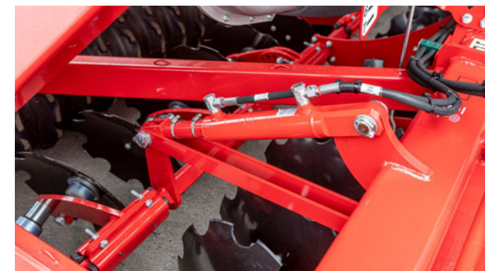
Hydraulicznie regulowany DiscSystem z dobrze znanym wskaźnikiem głębokości
