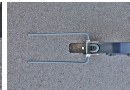
Proste zgrzebło za redlicą siewną TurboDisc prowadzone jest pojedynczo, co zapewnia bardziej wydajną uprawę gleby
