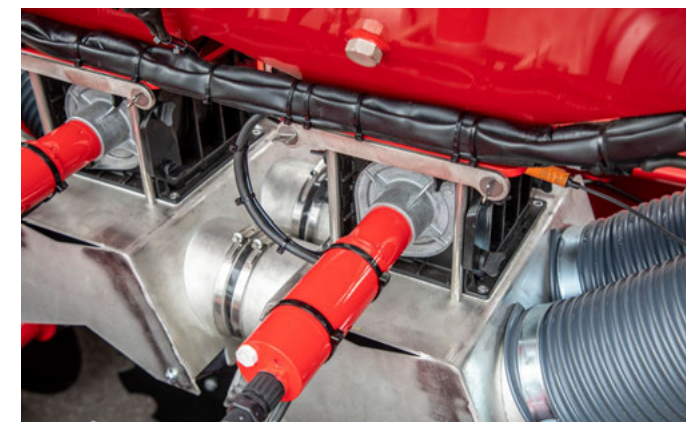
System zbiorników ciśnieniowych z możliwością odcinania dopływu nasion
