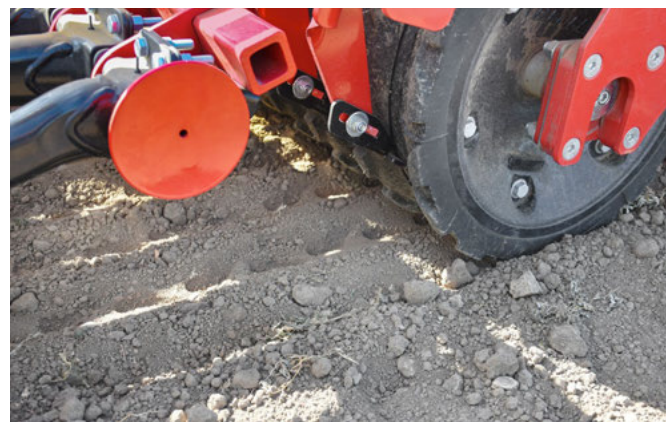
Zmniejsza zaskorupienie gleby dzięki pasowemu wtórnemu zagęszczaniu
