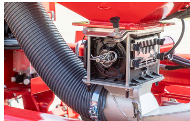
Urządzenie dozujące – system zbiorników iniekcyjnych z zasuwą
