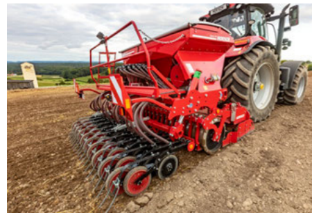
Hydrauliczna regulacja głębokości wysiewu za pomocą klipsów
