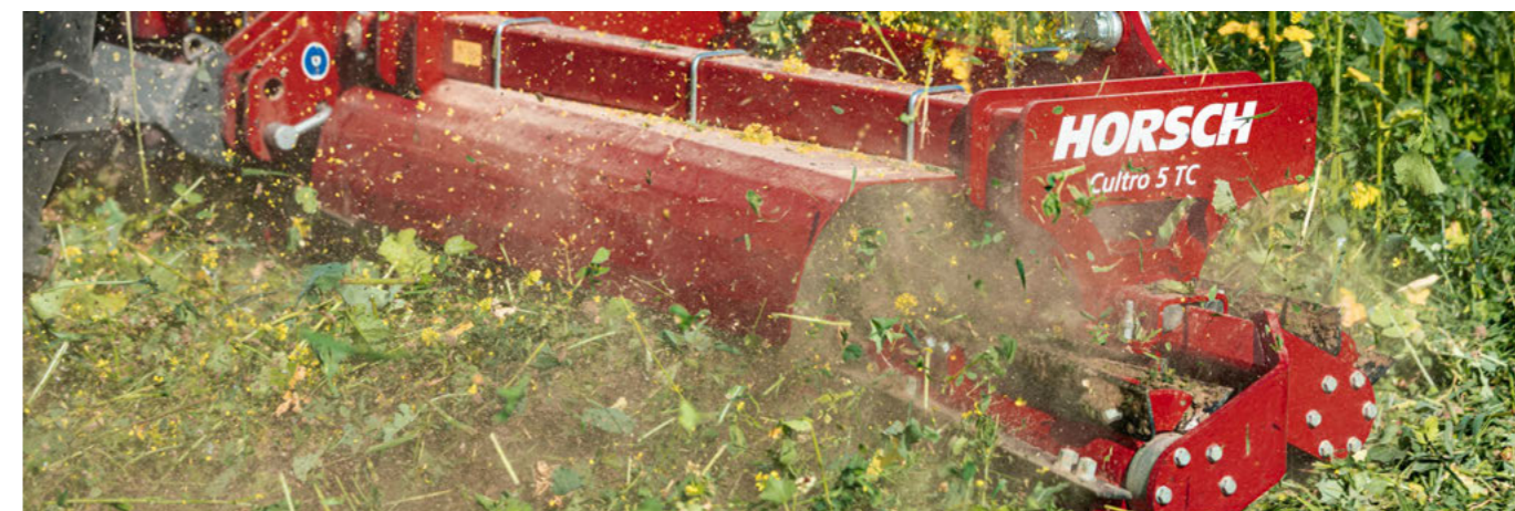
Podwójny wał nożowy zapewniający idealną wydajność rozdrabniania
