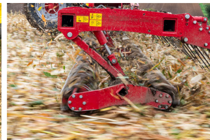
Podwójny wał nożowy o teoretycznej długości cięcia wynoszącej 14 cm
