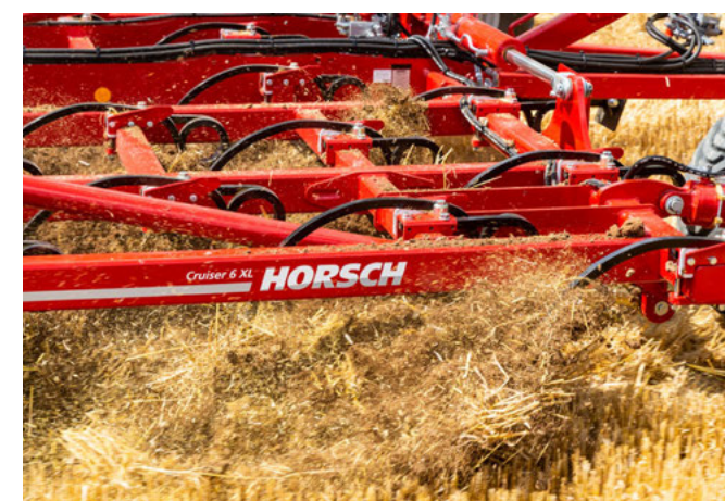
Zęby sprężynowe HORSCH o sile napięcia wynoszącej 150 kg
