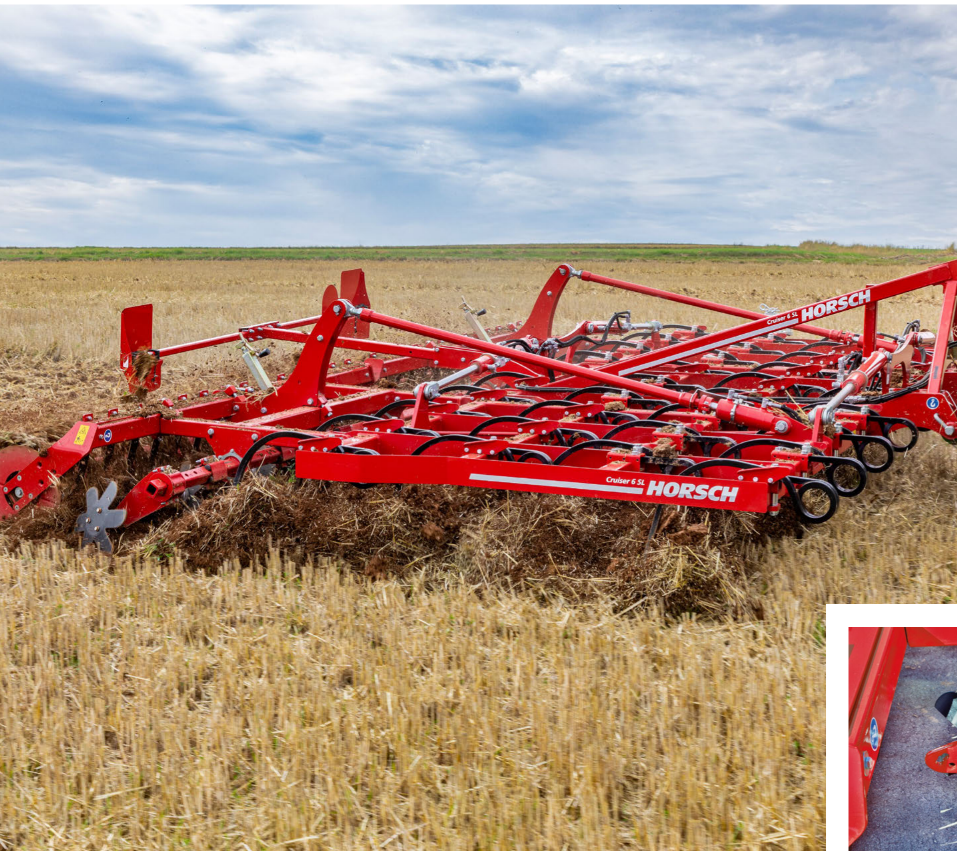
Talerze wyrównujące osadzone na łożyskach gumowych zapewniają ochronę przed przeciążeniem
