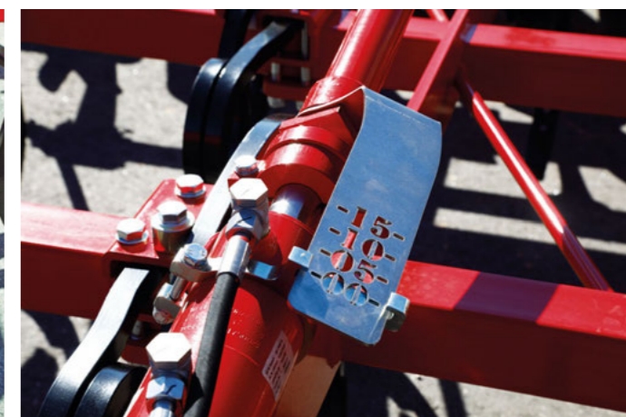
Opcjonalna hydrauliczna regulacja głębokości roboczej
