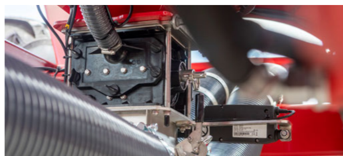
Автоматизоване електричне відключення внесення компонентів на половину ширини захвату шляхом підключення функції SectionControl
