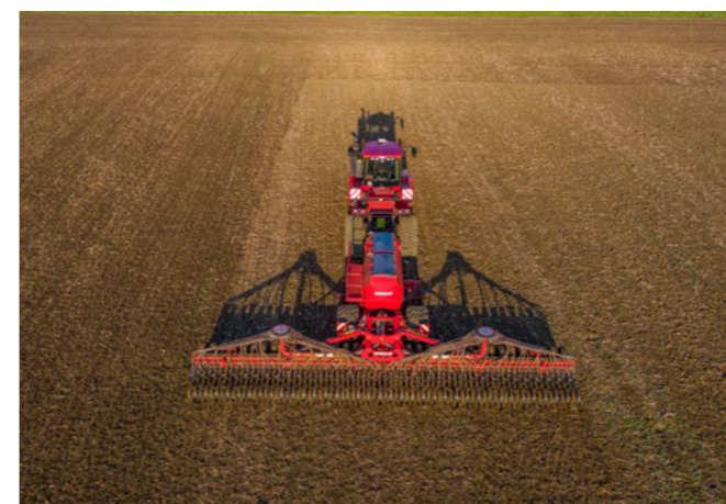
Чітке витримання заданої глибини висіву кожним сошником завдяки гідравлічному перенесенню ваги бункера на крила сівалки
