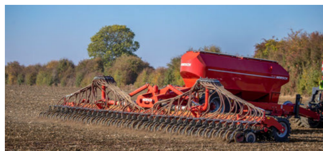
Серійно з механічним відключенням внесення компонентів на половину робочої ширини захвату
