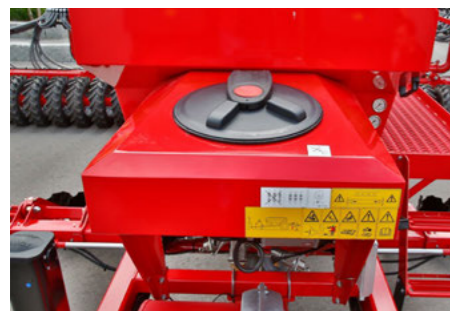
Опція для мікрогрануляту надає можливість одночасно дозувати й вносити третій компонент
